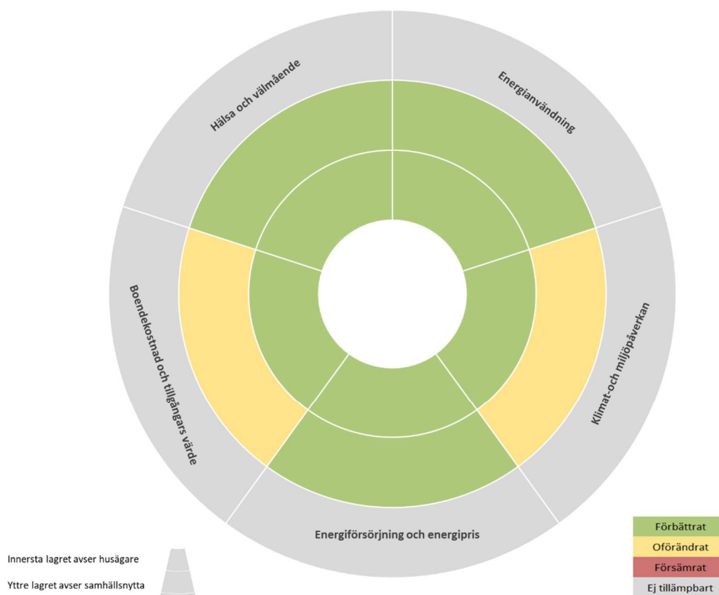
Figur 17: Visualisering av mervärden av tillvalet kombinerat värme- och ventilationssystem (bergvärmepump och FTX) för Fiskarhedenvillans hus Tidlös 05.
