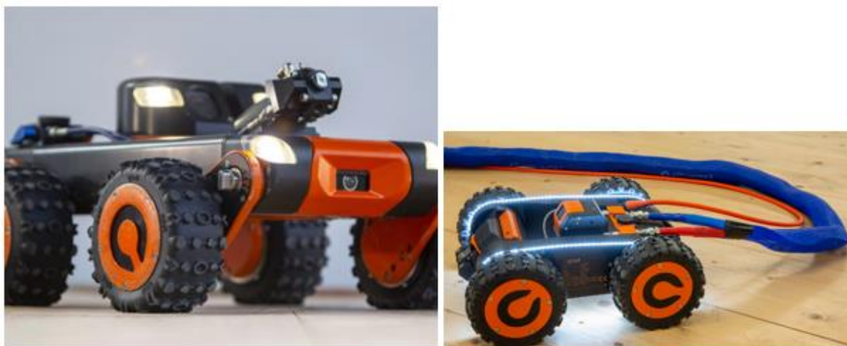
Figur 15: Q-bots sprutrobotar Betty (vänster) och Emmeline (höger). 54
