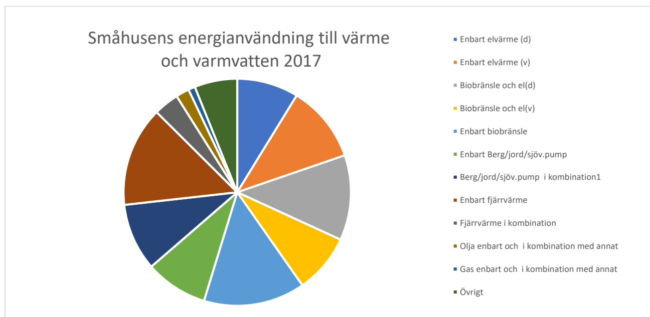
Figur 6. Småhusens energianvändning till uppvärmning och varmvatten 2017, fördelat efter uppvärmningsform. Källa: (Energimyndigheten) (d) = direktverkande el, (v)= vattenburet system. Notera att i direktverkande el ingår även luft-luft värmepumpar.
