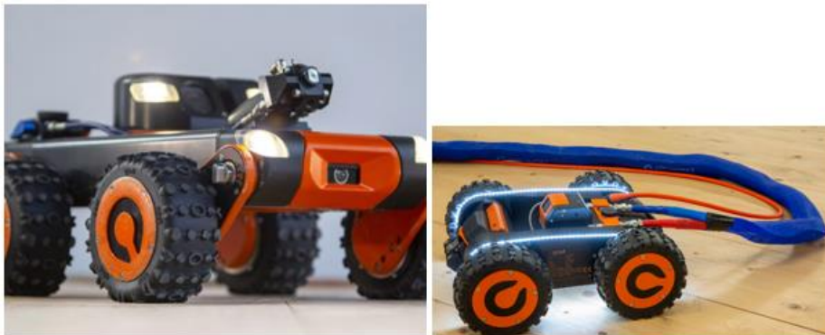
Figur 15: Q-bots sprutrobotar Betty (vänster) och Emmeline (höger) 54,55
